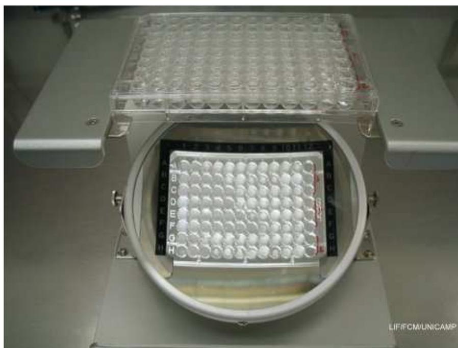
Figura 39: Sistema de leitura da placa de microtitulação com auxílio de espelho.
