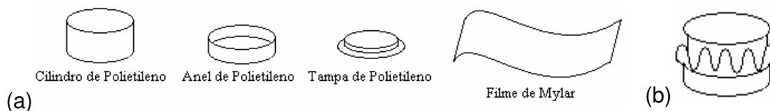
**Figura 11.** (a) Componentes da cela de polietileno específica para análise por EDXRF; (b) Cella pronta para ser irradiada.
