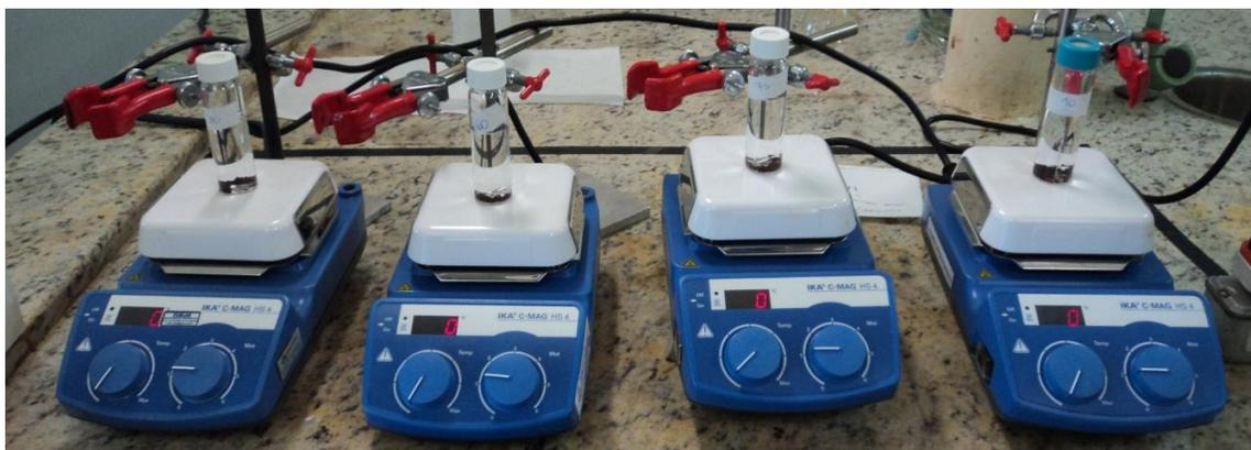
Figura 5. Agitação de esferas em solução de AS para determinar o intervalo de tempo necessário para atingir o equilíbrio de sorção-dessorção.
