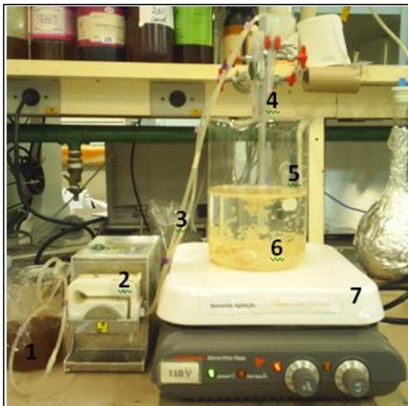
Figura 4. Sistema de gotejamento e coagulação de esferas de quitosana. (1) Solução de quitosana ou quitosana/TiO<sub>2</sub> P-25; (2) bomba peristáltica; (3) tubos de tygon; (4) agulha sustentada pela ponteira plástica; (5) solução de NaOH 12%; (6) esferas geleificadas; (7) agitador magnético.
