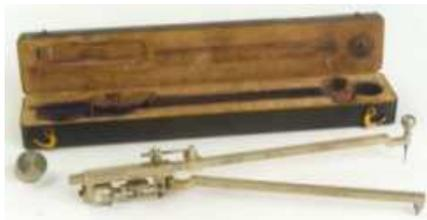
Figura 2.17: Imagem de um planímetro de Amsler, extraída de [16].
