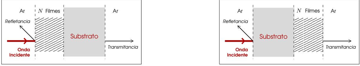
FIGURA 2.7 – Esquerda: representação esquemática para a transmitância e a refletância no caso de  $N$  filmes ‘em cima’ do substrato. Direita: representação esquemática para a transmitância e a refletância no caso de  $N$  filmes ‘embaixo’ do substrato.
