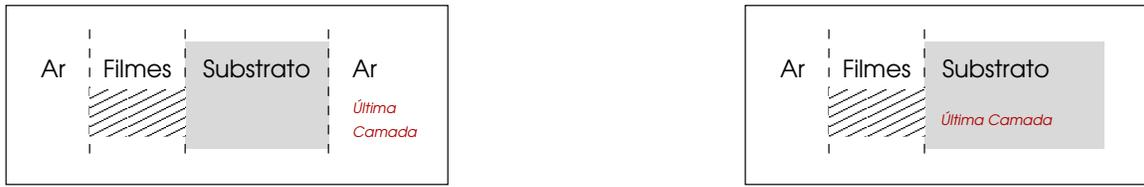
FIGURA 2.3 – Esquerda: sistema com substrato finito, sendo a ‘última camada’ composta de ar. Direita: sistema onde o substrato é a ‘última camada’ e portanto semi-infinito.
