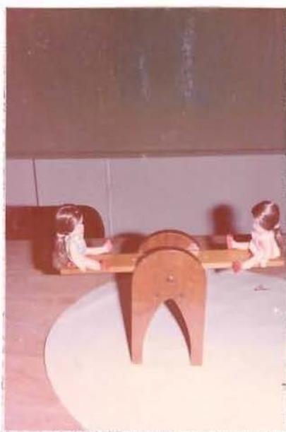
Fig. 13 - *Alavanca Interfixa*.
