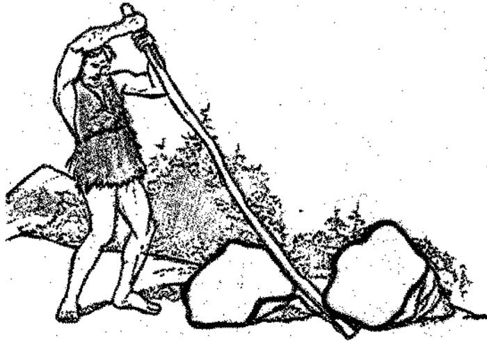
*A alavanca e seus elementos:* A alavanca simples não é mais do que uma barra comprida que se equilibra num ponto que pode ficar ou não no seu centro, nada menos que uma gangorra. O ponto em torno do qual a gangorra se move, ou onde se apoia, recebe o nome de *fulcro* e qualquer uma das distâncias que vão das extremidades da alavanca ao seu fulcro chama-se *braço da alavanca*.
