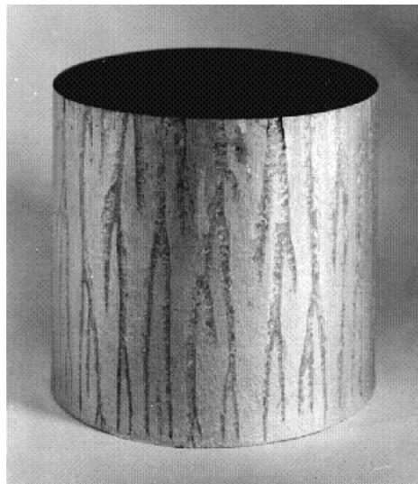
Figura 4.17: Peça metálica com freckles. Tomada de <http://www.icaen.uiowa.edu/becker>.
