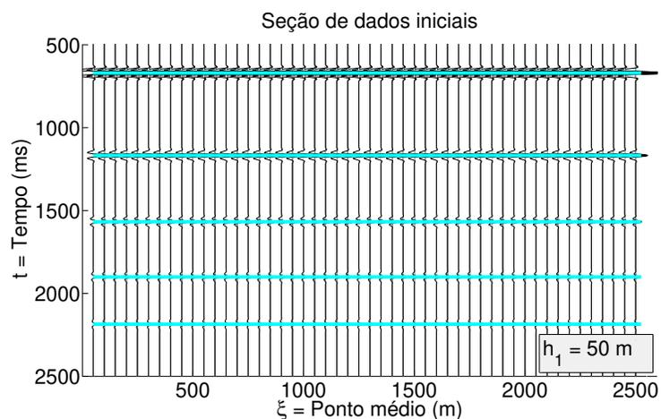
Fig. 5.2: Sismograma sintético de uma seção de afastamento comum com meio-afastamento de 50 m e cada curva em azul claro é a curva de tempo de reflexão referente a cada camada do modelo da Figura 5.1.
