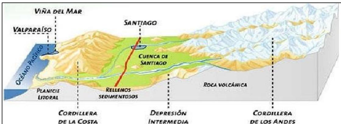
Figura 3.2: Perfil topográfico esquemático da bacia de Santiago.
