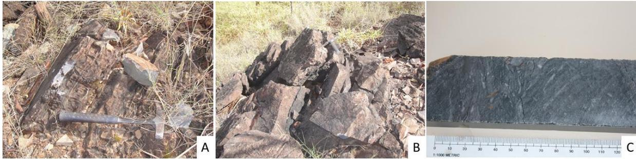
**Figura 7. 20. (a) Dolomito cinza laminado da Formação Morro do Calcáreo na área da ocorrência Olho D'Água; (b) Dolomito levemente brechado, cinza a róseo, da Formação Morro do Calcáreo; (c) Dolomito cinza laminado em testemunho da sondagem VZODF001.**
