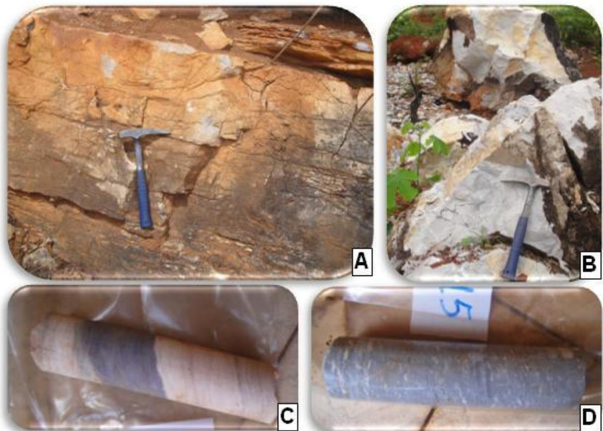
**Figura 7. 48. (a) Dolomito laminado, rosa, da Formação Serra do Poço Verde; (b) Dolomito cinza, maciço da Formação Morro do Calcáreo; (c) Dolomito rosa com intercalação de metapelito em testemunho de sondagem – Formação Serra do Poço Verde; (d) Dolomito cinza, laminado em testemunho de sondagem – Formação Morro do Calcáreo.**
