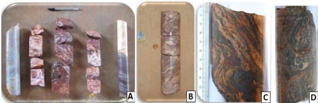
**Figura 7. 52. (a) Sequência de amostras representativas da evolução da brecha dolomítica da ocorrência zincífera Pamplona; (b) Dolomito brechado rosa (c) Rocha dolomítica com hematita e dolomita, cisalhado da zona de brecha; (d) Zona mineralizada com willemita e hematita, com estruturas de cisalhamento.**
