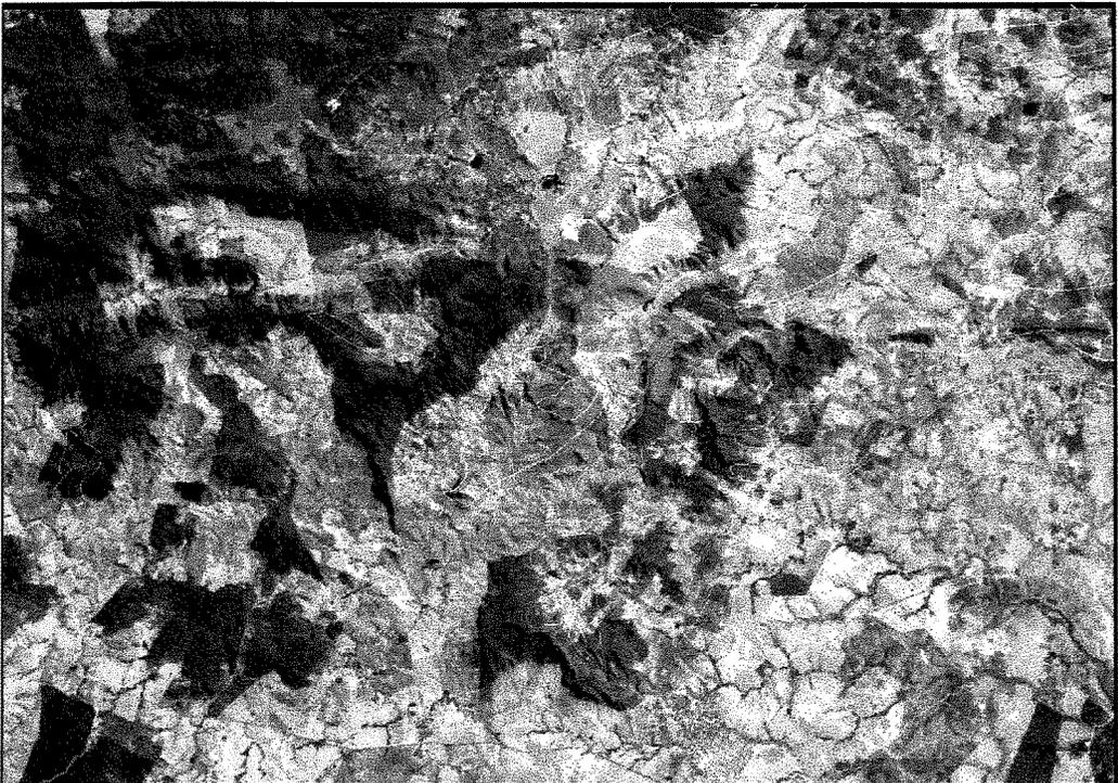
Figura 4.7. Composição colorida falsa-cor: bandas 356 (RGB). Da mesma forma que a banda ETM+\_7, a banda ETM+\_6 (termal) contribui na assinatura espectral das formações ferríferas e das coberturas lateríticas (tons roxos na porção centro-noroeste da imagem).
