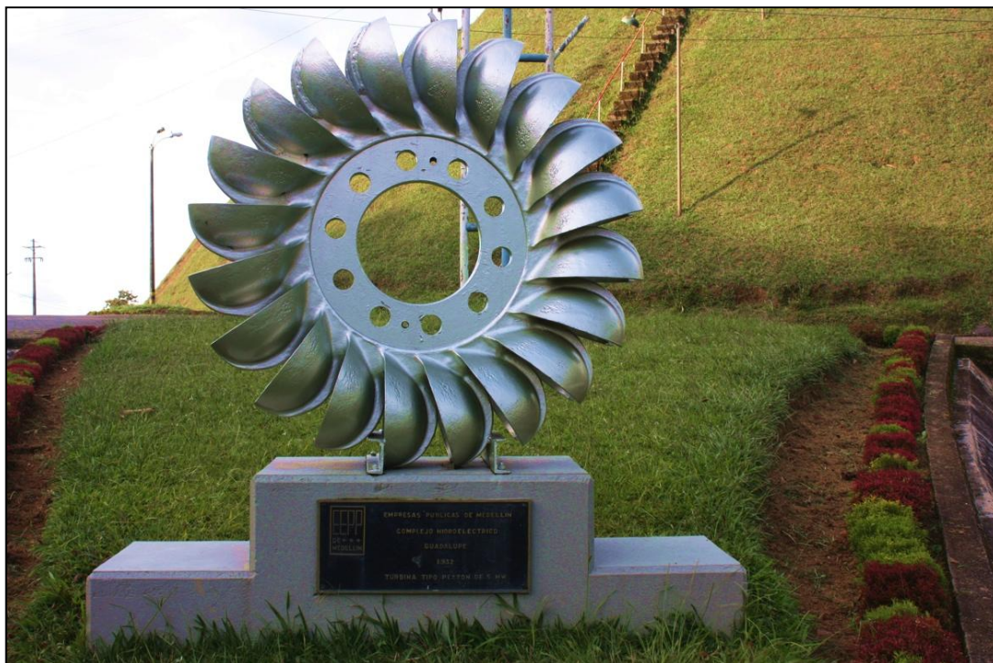
Fotografia. 03Turbina tipo pelton de 5 MW. Foi usada no projeto hidroelétrico Guadalupe I em 1932.
