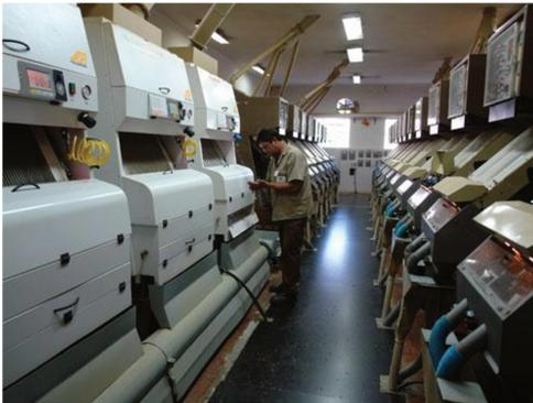
**Foto 3.14** - Equipamentos eletroeletrônicos para classificação de café.
