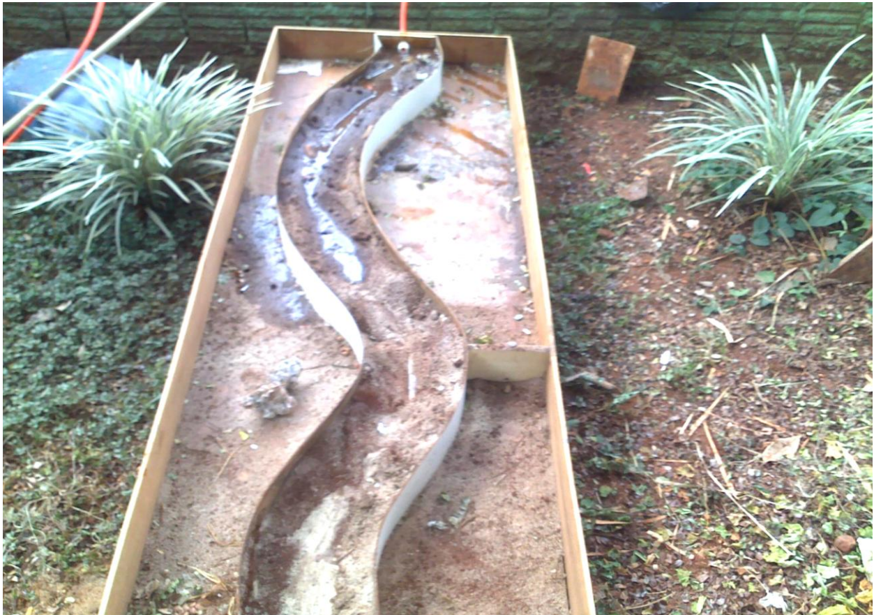
Figura 4.1 - Modelo de curso de água para simular um rio (medidas: 2,10m de altura por 0,90m de largura).
