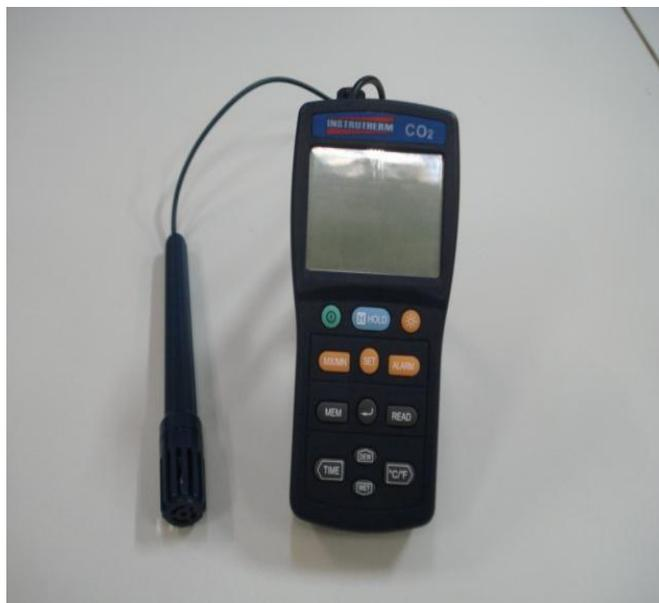
**Figura 3.3.** Analisador de CO<sub>2</sub>, modelo C-02 – Instrutherm.
