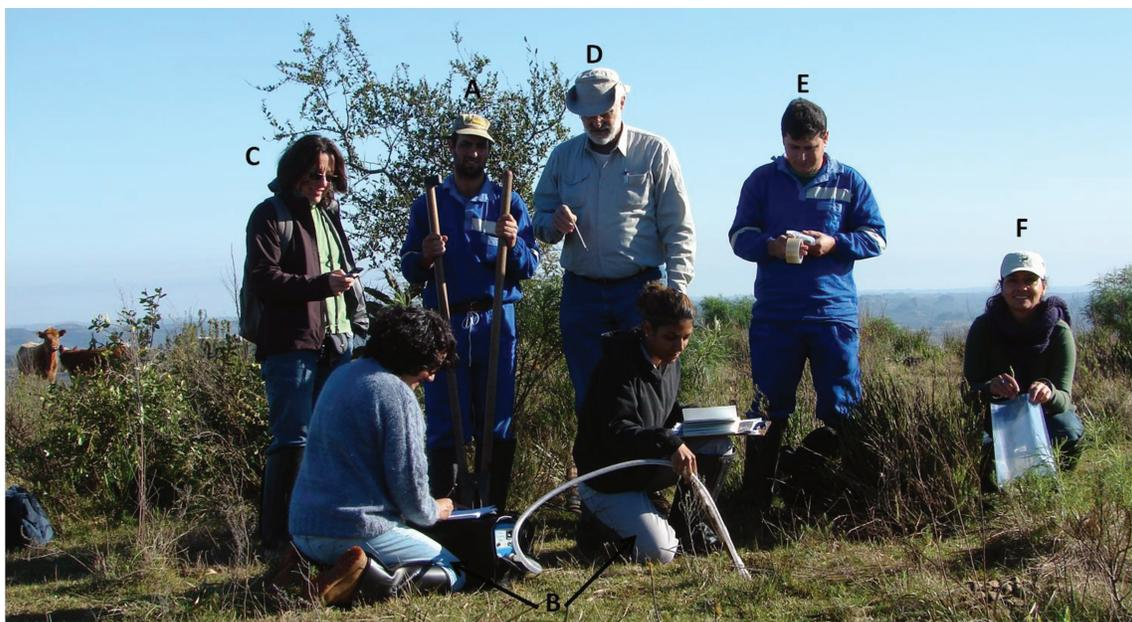
**Figura 6.4** Foto ilustrativa da amostragem e de medição em campo de gases de Hg: (A) escavação do local com a boca-de-lobo; (B) medição do Hg gasoso no solo durante 34 segundos corridos; (C) cronometragem do tempo; (D) obtenção da temperatura do solo e ambiente; (E) coleta de solo; e, (F) coleta de vegetação.
