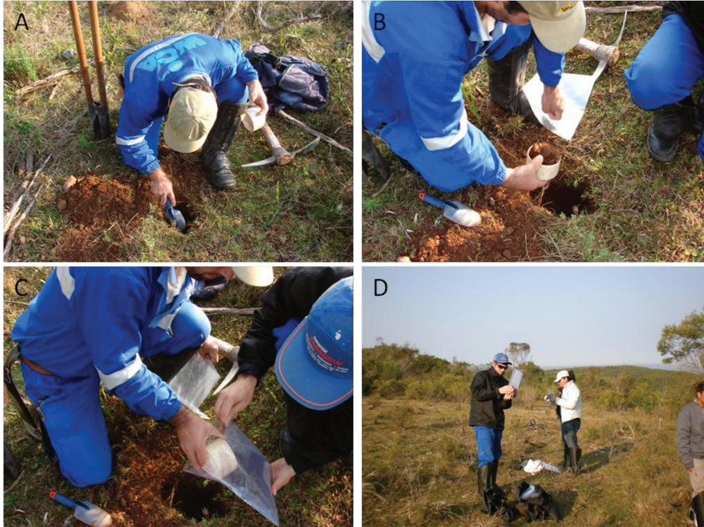
**Figura 6.5** Fotos ilustrando o procedimento adotado na coleta das amostras de solo: (A) limpeza das paredes do buraco; (B) coleta da amostra com uma espátula de plástico; (C) acondicionamento da amostra em saco plástico; e, (D) vedação do plástico e etiquetagem da amostra.
