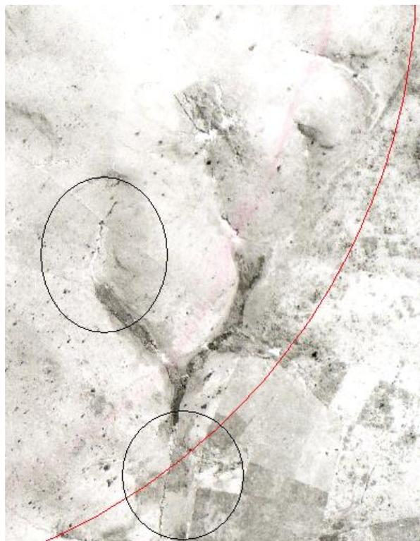
Figura 6.61: Erosão acelerada e remontante em afluentes do Córrego Favorita (ano 1962) – Amostra 19
