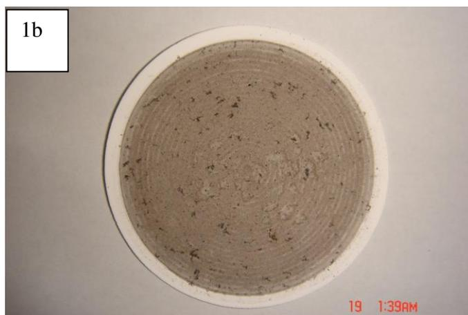
Fig. A1a. Coletor automático de água de chuva. A1b. Fração insolúvel da água de chuva retida em membrana de celulose após filtração.
