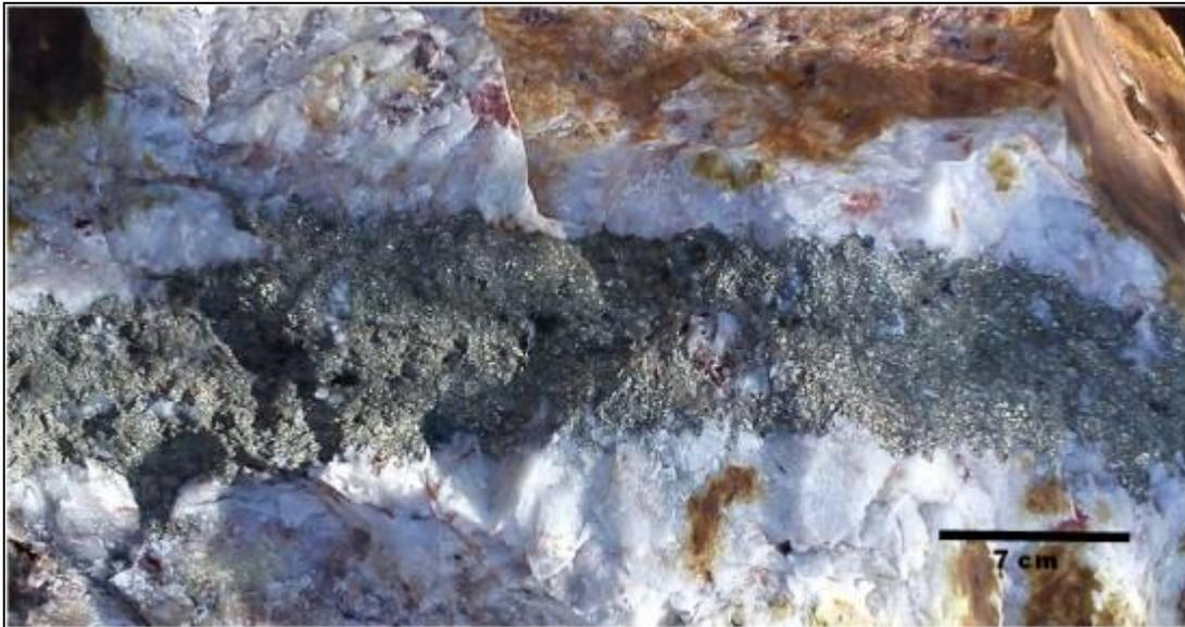
**Figura 13:** Foto, veio de quartzo com faixas estreitas e paralelas de sulfetos, principalmente pirita.
