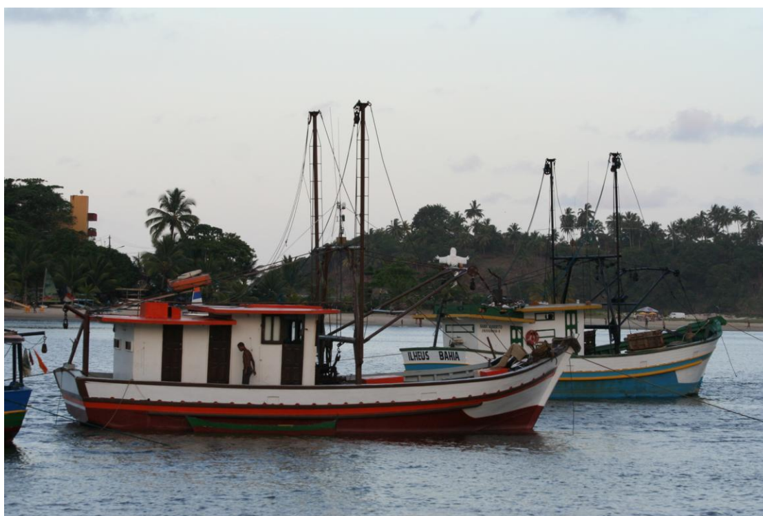
Figura 17 : Arrasteiros equipados para Arrasto duplo de camarão em Ilhéus-BA. Fonte: Trabalho de campo, 2010.
