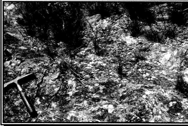
**Figura 3.21 - Superfície de oxidação do quartzo-sericita filito (Membro Serra da Anta) aflora próximo de Paracatu (MG)**
