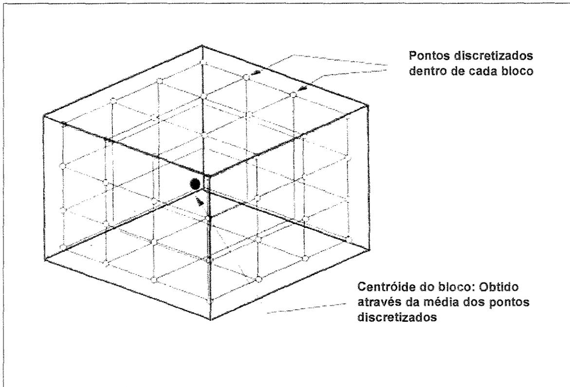
Figura 3.14: Discretização dos pontos dentro de cada bloco.
