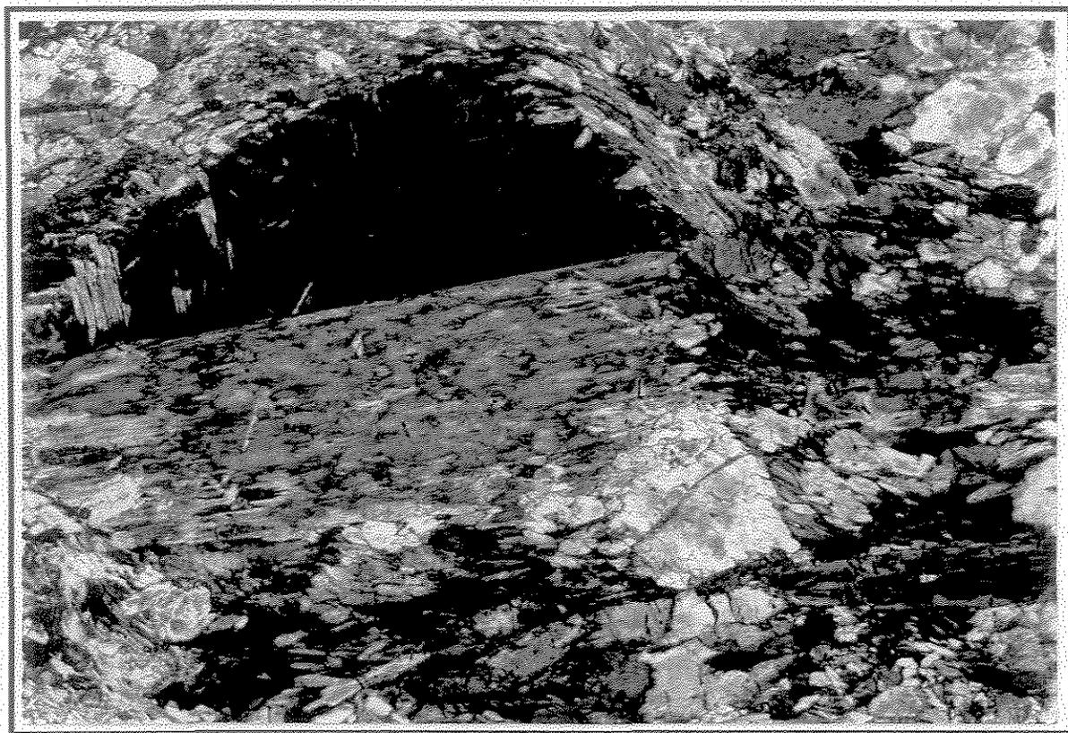
Fotomicrografia III.21 – Ponto 178 – Detalhe do metapiroxenito, onde ainda é possível observar a forma do antigo piroxênio, transformado para hornblenda. Filtros polarizadores cruzados e objetiva de 10X.
