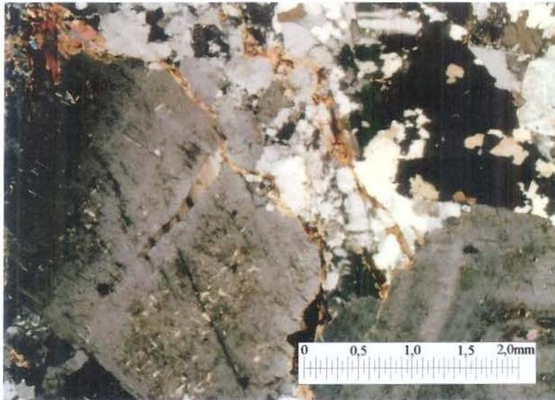
**FOTO 6.1.** Fotomicrografia exibindo fenocristal subédrico de plagioclásio que se encontra fraturado (Aumento 2,5 vezes, nicois cruzados). Essa fratura apresenta-se cicatrizada por agregados de quartzo (Amostra CL-AB 28A).
