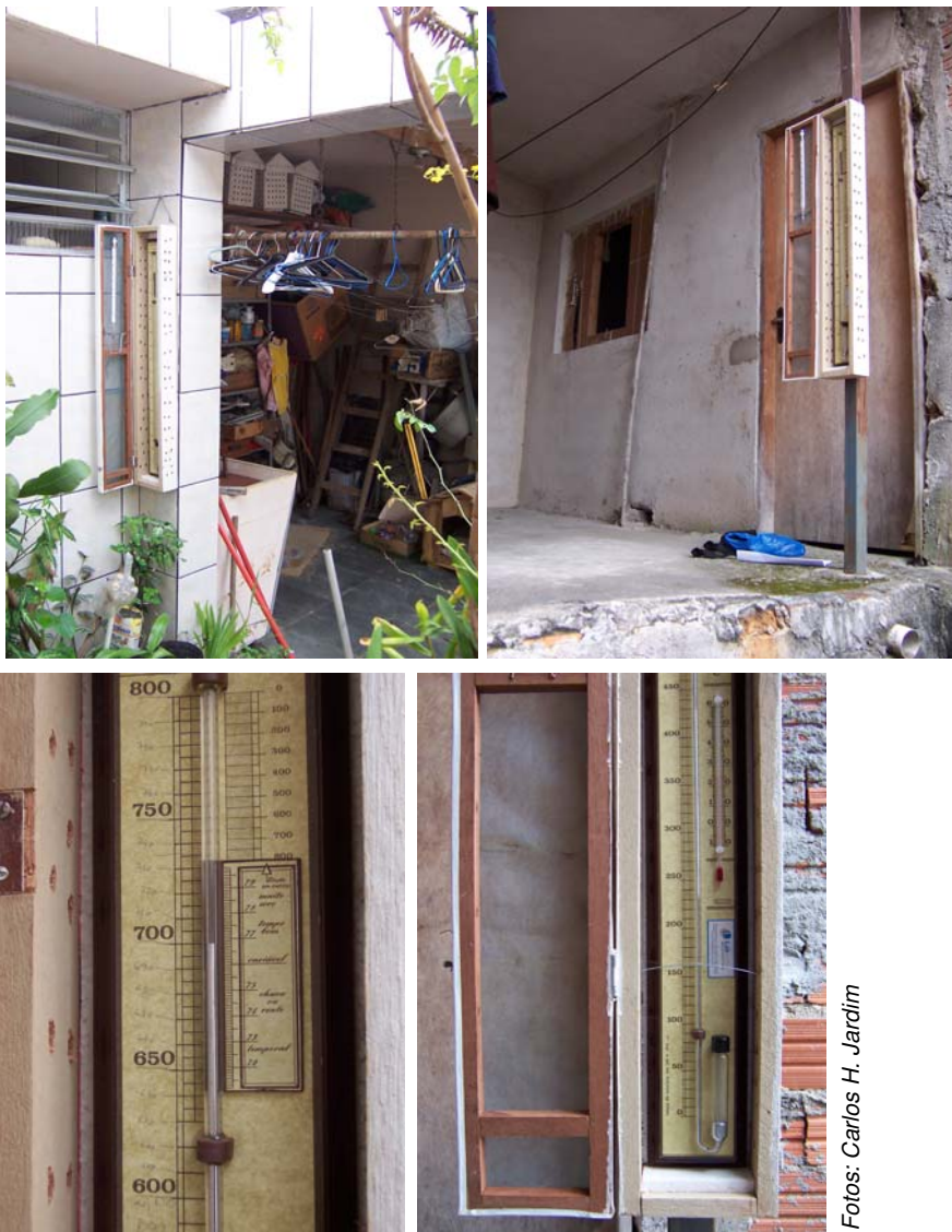
Figura 2.2 - Características e locais de instalação dos barômetros
