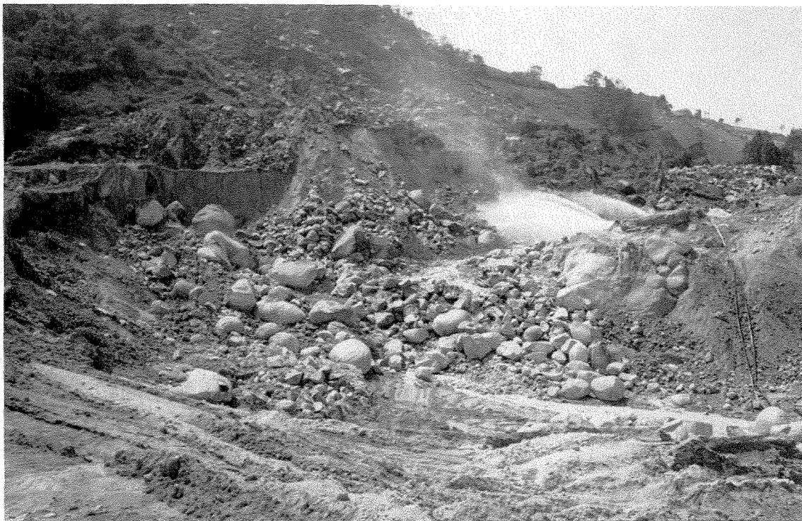
**FOTO IV.28 – Desmorte hidráulico utilizado para a extração de areia na Pedreira Sarpav**
