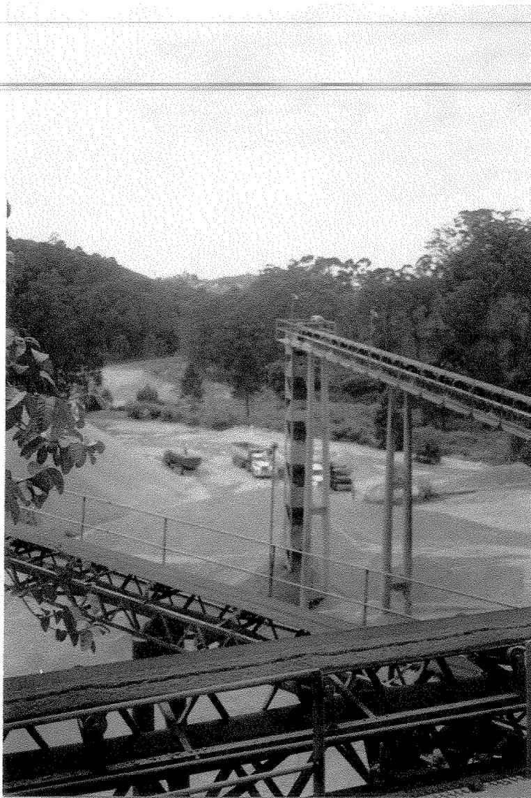
**FOTO IV.16 – Torre metálica instalada no pátio de estocagem da pedreira Cantareira para evitar a dispersão de partículas sólidas na atmosfera**
