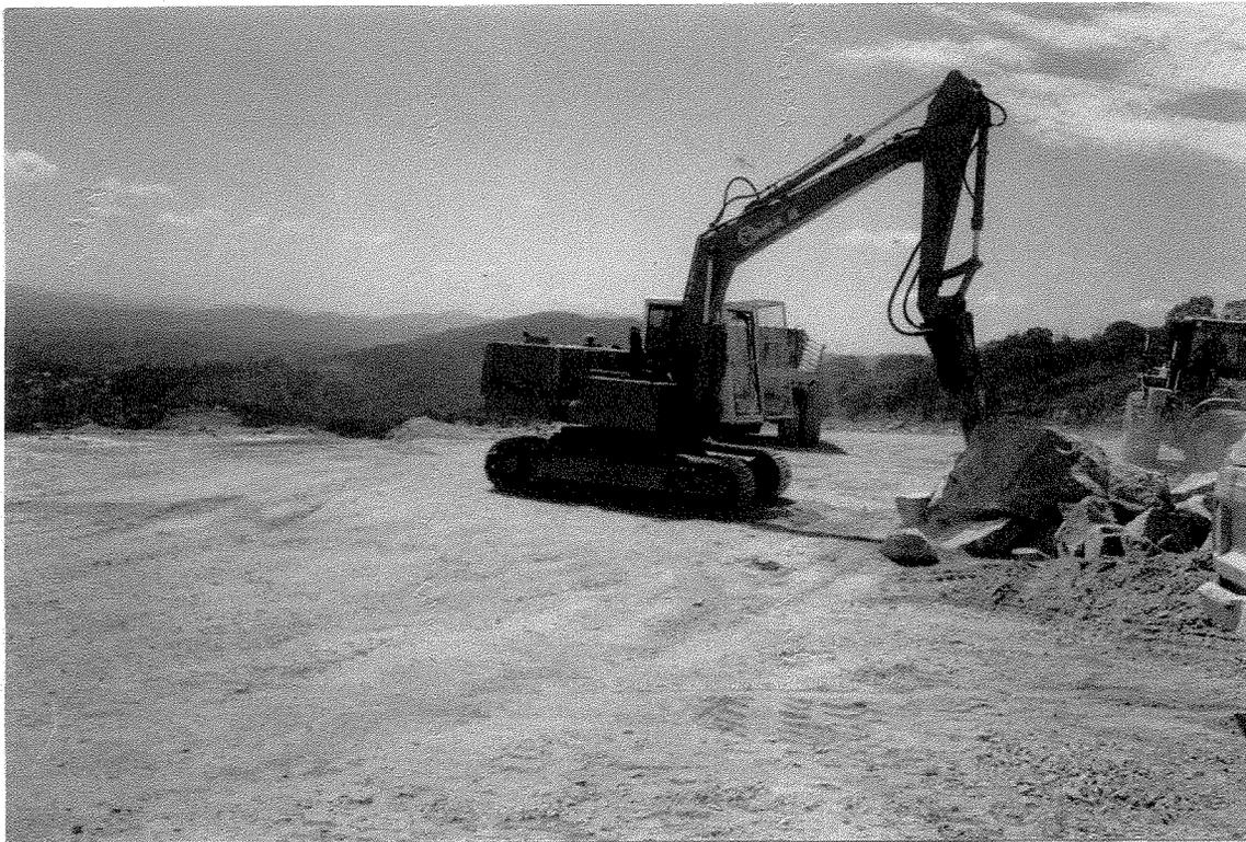
**FOTO IV.3 – Rompedor hidráulico (pica-pau) da Pedreira Embu**
