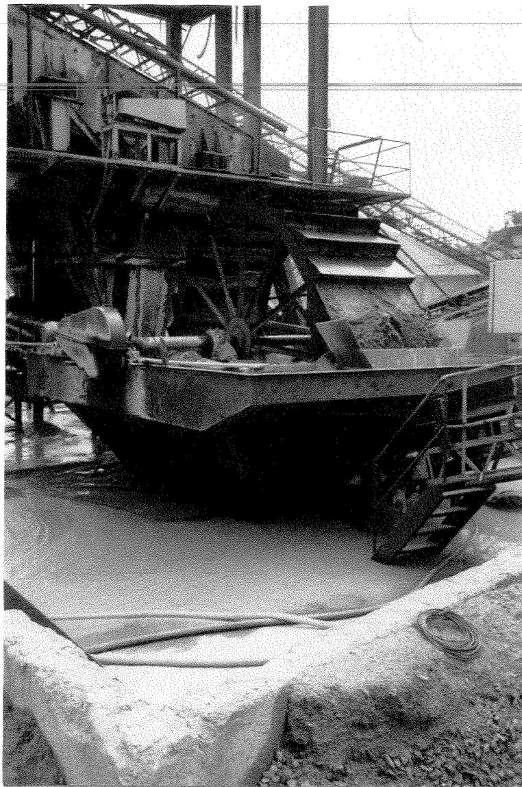
**FOTO IV. 30 – Tratamento da brita, por via úmida, na Pedreira Sarpav**
