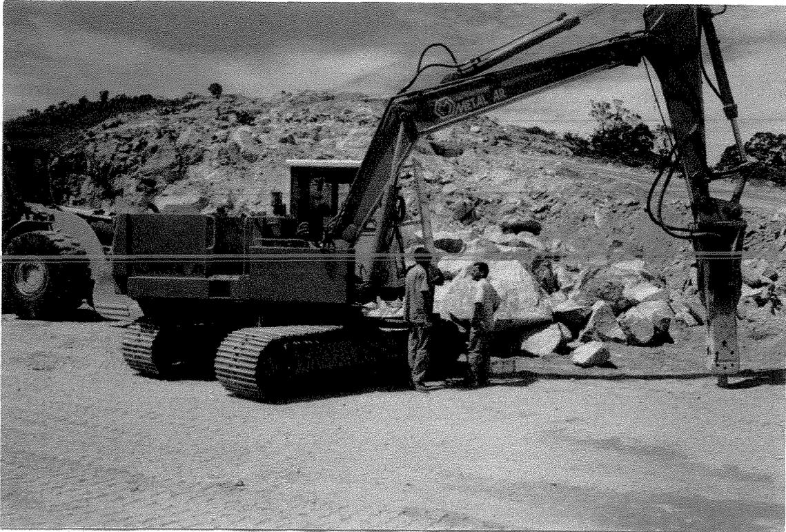
**FOTO IV.14 – Rompedor hidráulico (pica-pau) utilizado na Pedreira Cantareira**
