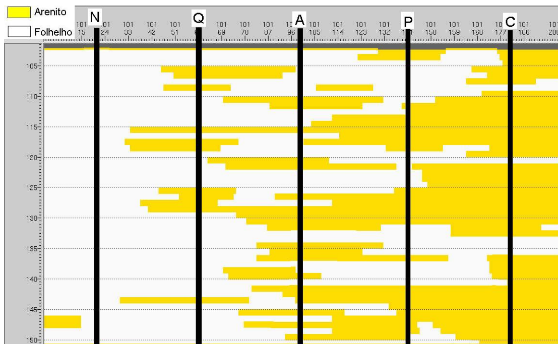
Figura 2.9: Seção atravessando os poços N, Q, A, P e C, mostrando o resultado da simulação e a variação de espessura conseguida para os corpos de areia.
