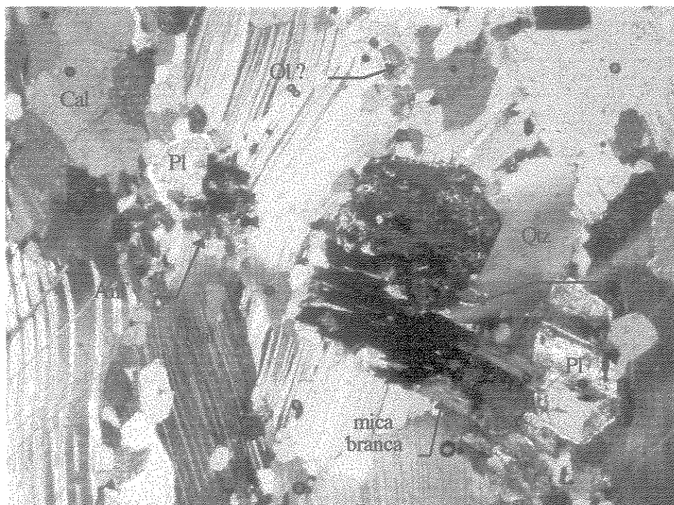
Figura 3.10 - Fotomicrografia da porção mais impura dos níveis de mármore. Observe os grandes cristais de calcita com lamelas de geminação desfeitas, indicando a participação de deformação mecânica neste litotipo. Luz transmitida, nicóis cruzados, objetiva de 2,5 X 10 vezes.
