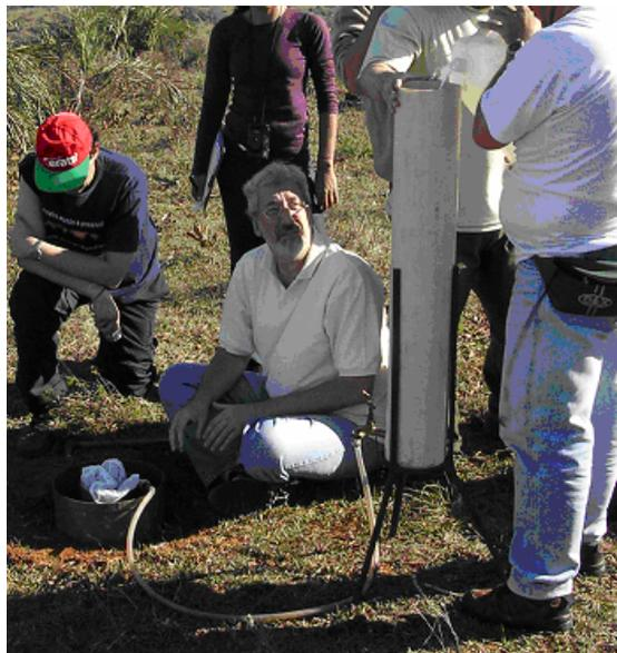
Figura 5.2.1.1: O método dos círculos concêntricos
