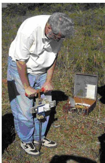
Figura 5.2.1.2 – Utilização do Penetrógrafo em campo.
