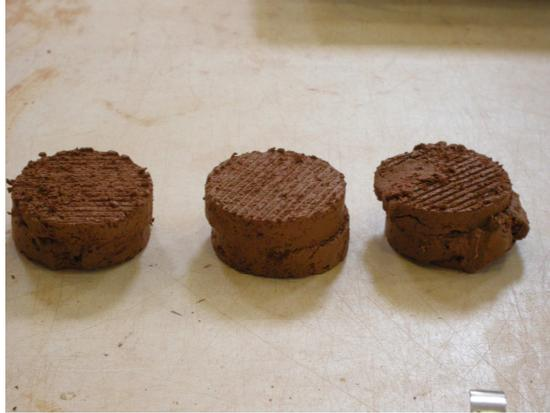
Figura 9: Foto dos Corpos de Prova Cisalhados nas Três Diferentes Umidades Citadas no Texto.
