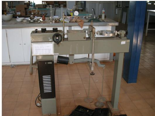
Figura 8: Foto do Aparelho Usado no Cisalhamento Direto do Laboratório de Geotecnia da Faculdade de Eng. Civil da UNICAMP.
