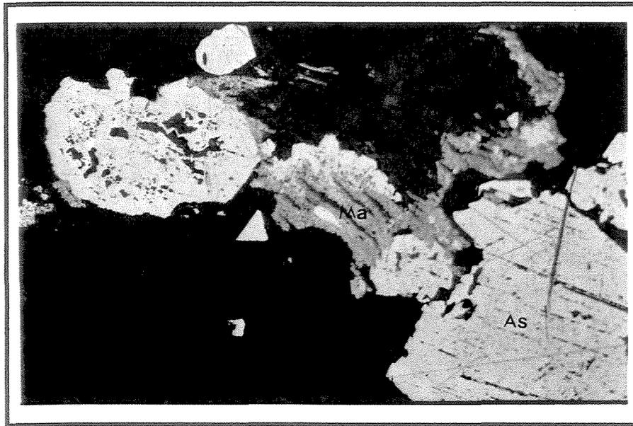
Foto 3.32. Marcassita (Ma) localizada nas bordas da arsenopirita (As), resultante da substituição desta (AM- 03 F-4 10 x luz natural).
