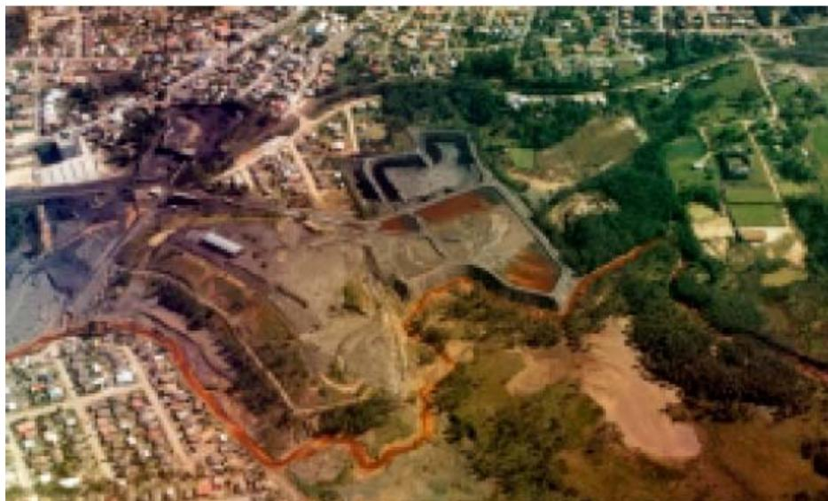
Foto 7.15. Vista aérea de uma instalação de beneficiamento de carvão e áreas adjacentes na bacia carbonífera de Santa Catarina. Observar drenagem ácida no curso d'água natural. Fonte: (CETEM, 2001).
