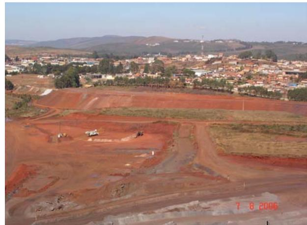
Foto 7.9. À esquerda, situação atual da cava da Mina de Capão Xavier (setor norte). À direita, pilha de estéril que funcionará como barreira visual e sonora para o Bairro Jardim Canadá, construída no limite da cava final projetada (setor sul).
