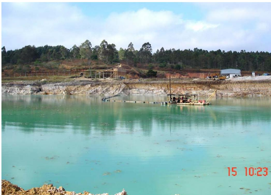
*Foto 7.11. Extração de areia em cava alagada com emprego de draga de sucção, da VCN Mineração.*
