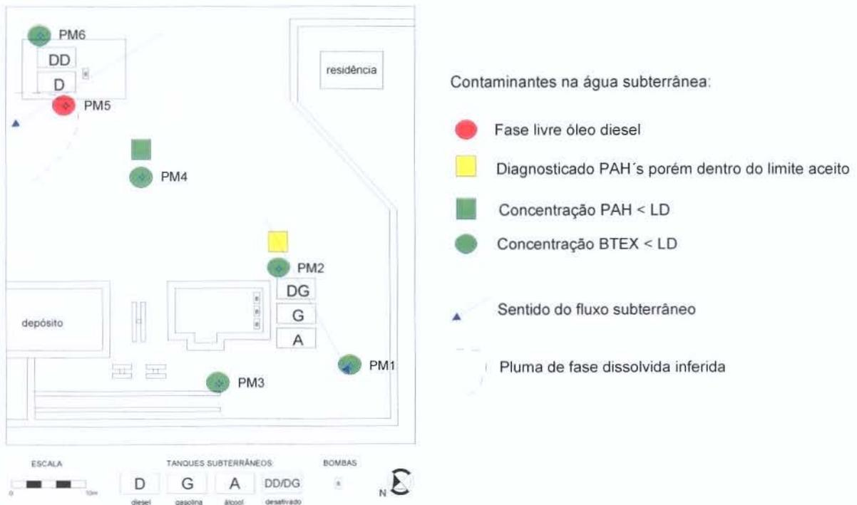
Figura 37: Síntese das concentrações de hidrocarbonetos na água subterrânea.
