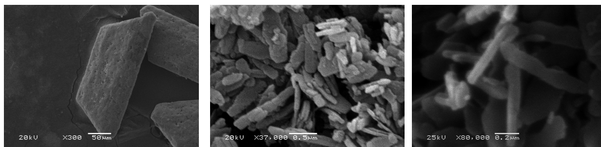
Figura 6.1 – Cristais de P-Mapa ampliados 300 vezes (esquerda) e nanocristais homogeneizados sob alta pressão ampliados 37 mil e 80 mil vezes por microscopia de varredura eletrônica (Duran et al. , 2008b)
