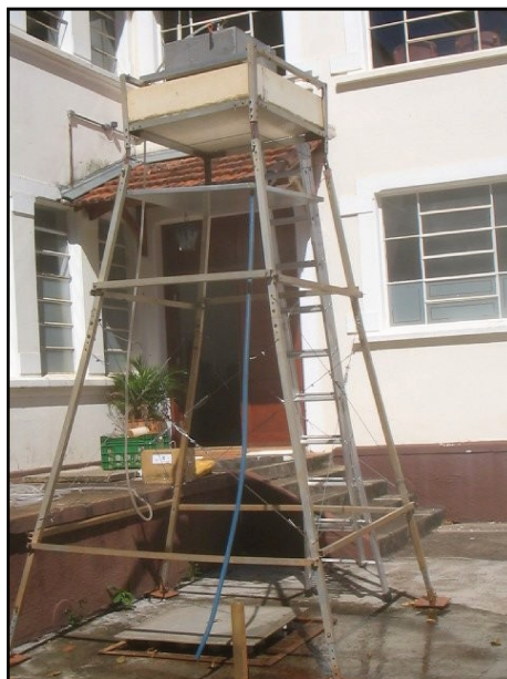
Figura 3.11 Simulador de chuva modelo Goettingen
