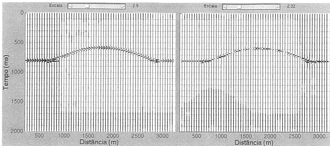
Figura 7.8: Sismogramas do dado sísmico modelado no InterSis (direita) e do dado sísmico modelado no LabSis (esquerda).
