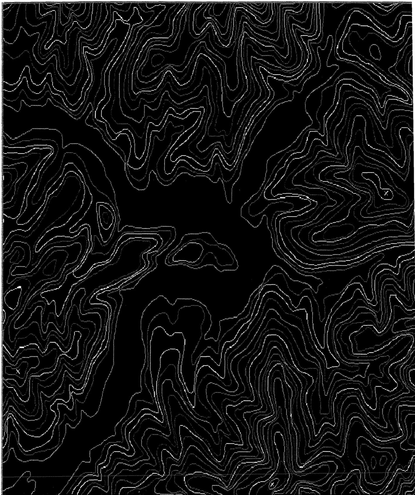
Fig.no 5.1- Mapa vetorial no formato DXF, oriundo da vetorização das cartas planialtimétricas realizada pelo ACTRACER. Cada curva de nível "mestra" possui uma cor e as intermediárias são constantes.
