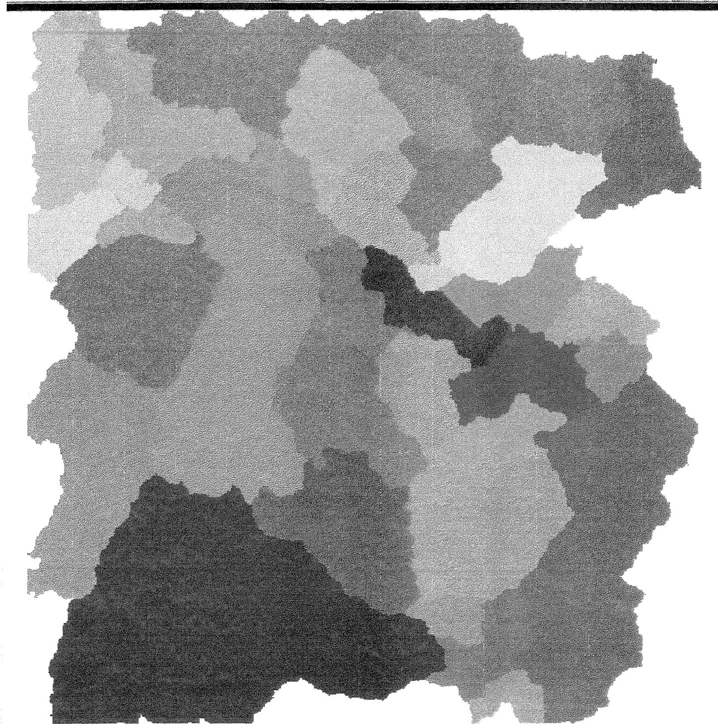
Fig.no 5.5- Mapa das sub-bacias geradas a partir do Modelo Digital de Terreno (MDT), usando-se uma resolução espacial de 50 metros.
