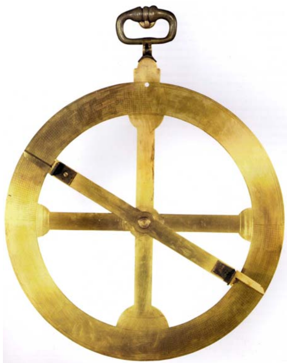
Figura 45: Astrolábio náutico. In: Laboratório do Mundo (2004: 223)
