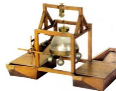
Figura 43: Modelo de Sino para mergulhadores. Apud: Laboratório do mundo (2004: 119).
