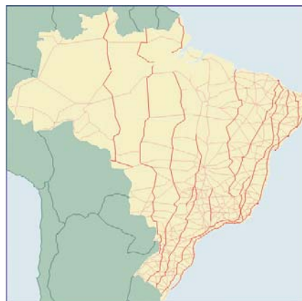
Rodovias longitudinais – prefixo BR-1XX
