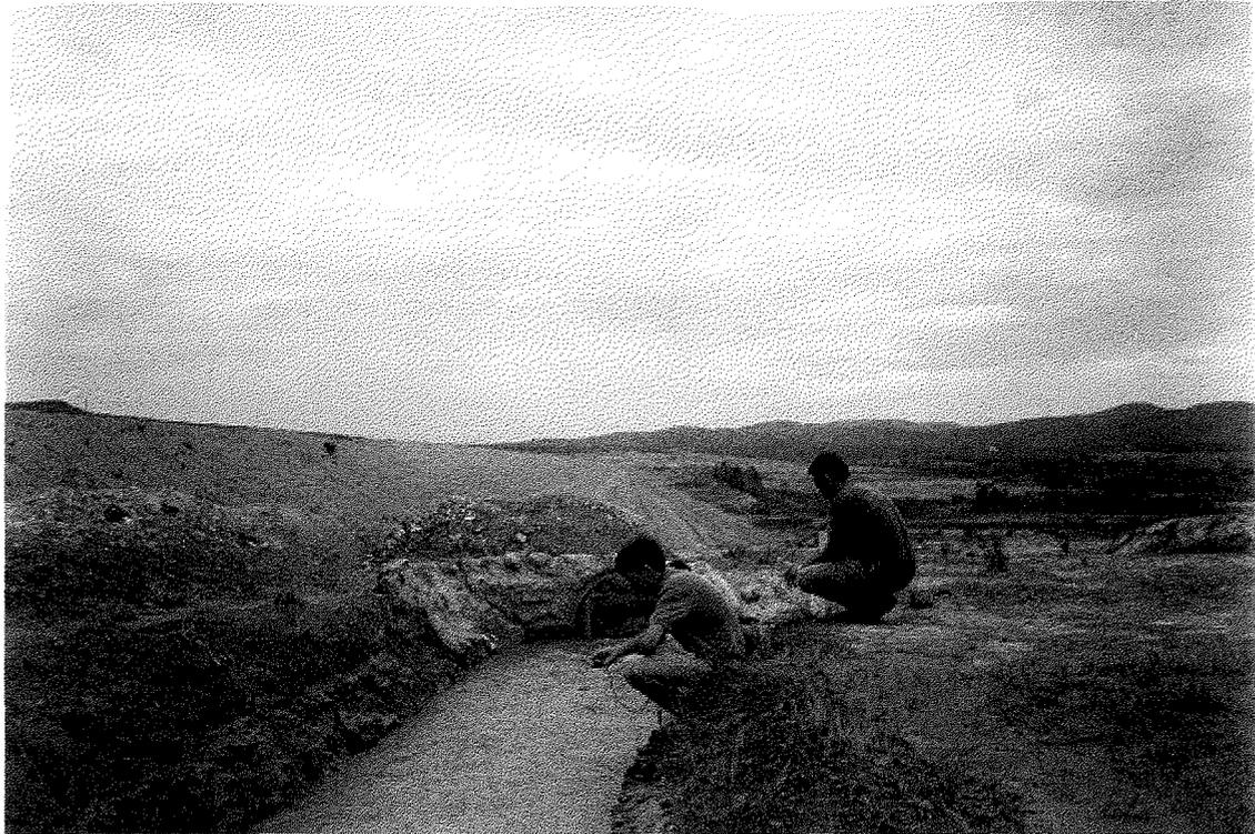
Foto 13 - Monitoramento da água da barragem de rejeitos, coletada no canal que a conduz para a estação de bombeamento.
