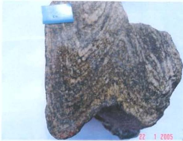
**Fotografia 5.4** Dobras intrafoliais isoclinais, desenvolvidas em rochas ortognaíssicas. Observar o bandamento de minerais máficos e félsicos. Plutão Abancay..
