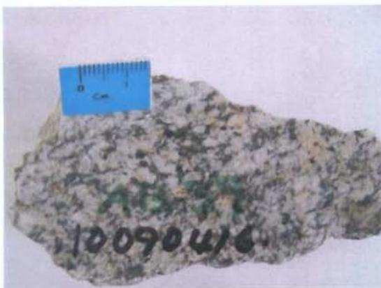
**Fotografia 4.14b** Metagranodiorito. Rocha granular holocristalina, grão médio, os cristais brancos pertencem ao plagioclásio, quartzo e feldspato potássico, os minerais pretos são representados por cloritas e minerais opacos.
