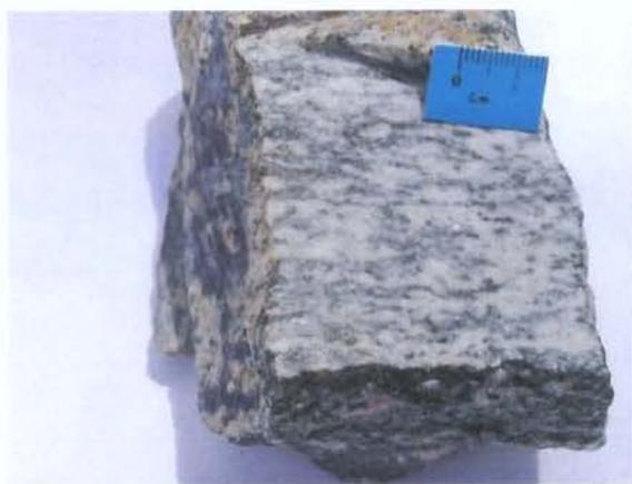
**Fotografia 5.8** Foliação incipiente em uma rocha ortognáissica, mostrando algum alinhamento de minerais máficos (biotita, anfibólio, epídoto) e félsicos alongados (plagioclásio, quartzo). ZPD.
