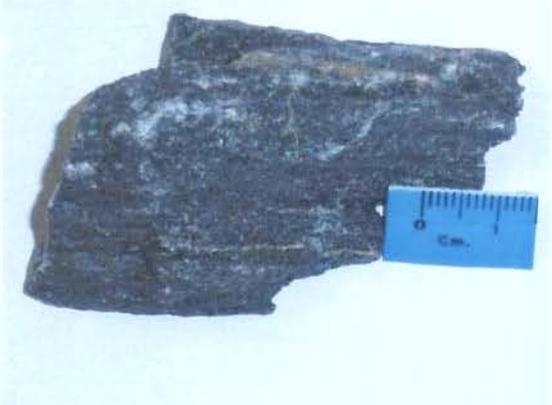
**Fotografia 4.11b** Ortognaisse anfibolítico. Rocha afanítica e fanerítica de cor verde cinzenta, com intercalação de finas faixas brancas. Os minerais ferromagnesianos são abundantes. Veios finos de cor verde atravessam subparalela e subperpendicularmente a direção de foliação. Foliação: mau definida.
