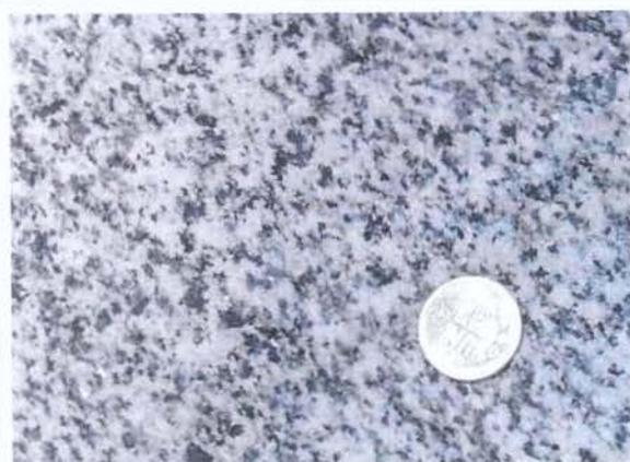
**Fotografia 5.9** Rocha com foliação magmática da zona pouco deformada ZPD.
