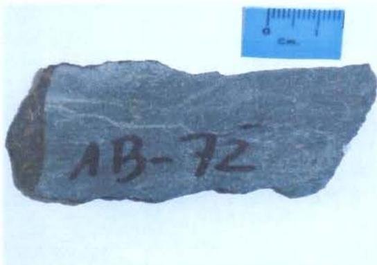
**Fotografia 4.9b** Ortognaisse anfibolítico. Rocha de cor verde escuro. A zona verde escura olha-se o tamanho afanítico dos minerais máficos e em outras zonas mais brancas olha-se minerais de feldspato de grão fino. Finos veios micrométricos verde-amarelados (ep-LCX) de aspecto fluidal incipientemente orientados paralelamente a direção da foliação. Outras cortan diagonalmente a foliação.
