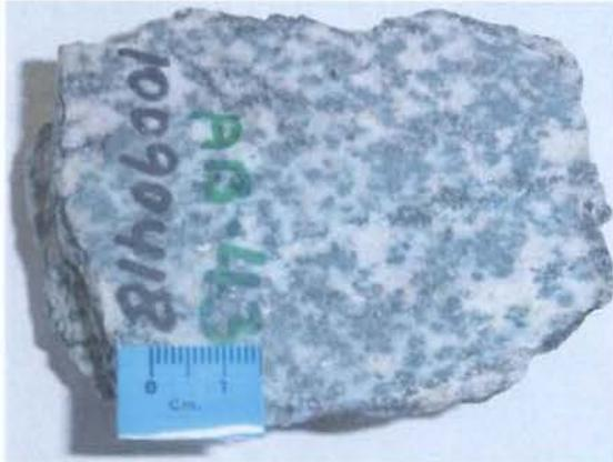
**Fotografia 4.15b** Metagranodiorito. Rocha holocristalina equigranular de grão média. O material branco é representado por feldspatos e quartzo, os minerais máficos são representados por biotita, anfibólio, cloritas e minerais opacos. Em setores observa-se um ligeiro alinhamento diagonal de alguns minerais máficos. A amostra apresenta um grau de coesão alto e fratura irregular.
