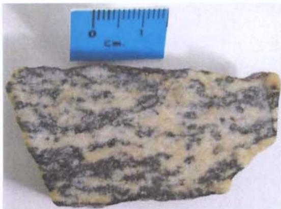
**Fotografia 4.16b** Ortognaisse com plagioclásio-biotita-quartzo. Rocha mesocrática cristaloblástica subequigranular, os cristais brancos estão representados essencialmente por plagioclásio, em menor proporção quartzo e feldspato potássico. Os minerais máficos estão representados por biotita e anfibólio. Observa-se uma lineação dos minerais. Foliação: Mau definida.
