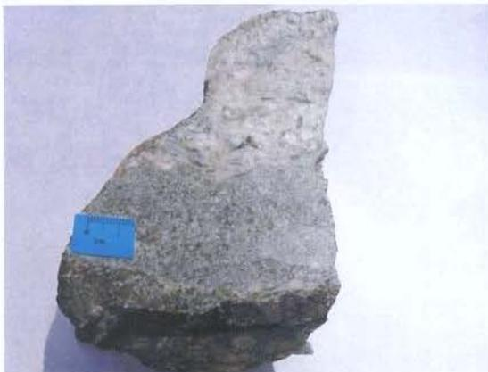
**Fotografia 4.7b** Ortognaisse de sericita-quartzo-anfibólio. Apresenta cor verde, essencialmente fanerítico de grão fino, grãos de feldspatos e quartzo intercrescidos com minerais de anfibólio e epidoto. Na borda o tamanho dos grãos aumenta e a presença dos ferromagnesianos é menor.
