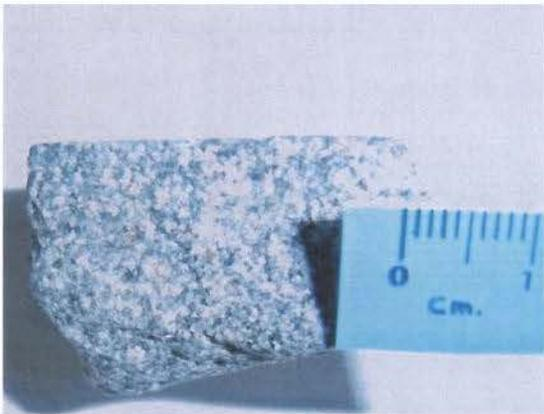
**Fotografia 4.8b** Ortognaisse de sericita-anfibólio-clorita. Rocha de cor verde cinzenta essencialmente fanerítica de grão fino, com grãos de anfibólio (verde escuro) intercrecidos com feldspato (branco). A amostra apresenta um escasso alinhamento de seus grãos. Finas e poucas disseminações de limonitas. Foliação: mau definida.
