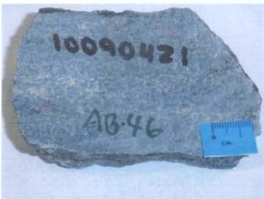
**Fotografia 4.13b** Ortognaisse anfibolítico. Rocha de cor verde acinzentado, fanerítica de grão fino composta por grãos de anfibólio e feldspatos alinhados. Foliação: mau definida.
