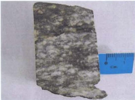
**Fotografia 4.17b** Ortogneisse com plagioclásio-quartzo-epidoto-biotita. Rocha cor cinza esverdeado, fanerítica, de grão fino a médio, composta por intercalação de faixas descontínuas de cor branca estão compostas por feldspato e quartzo, enquanto que as faixas pretas estão compostas por clorita e epidoto. Foliação: moderada.
