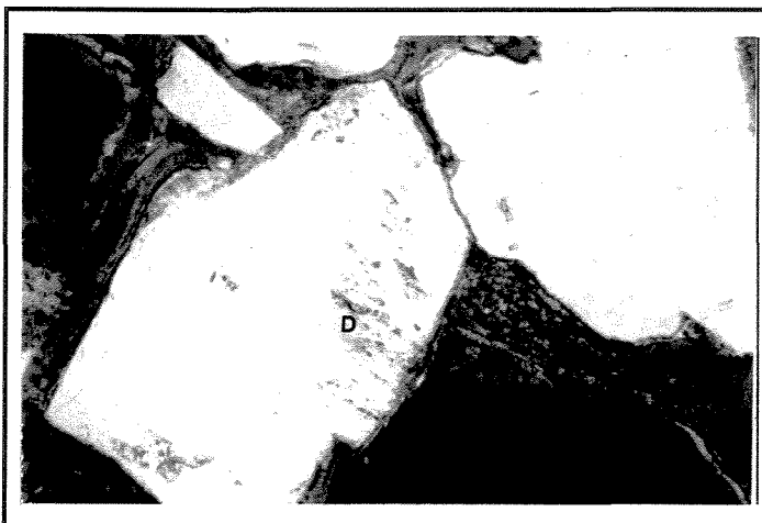
Figura 2.24 - Argila infiltrada mecanicamente após o crescimento secundário de feldspato potássico. Observar a contração desta argila e a dissolução incipiente (D) no interior do grão de feldspato. Polarizadores cruzados, 190x (Souza, 1988).
