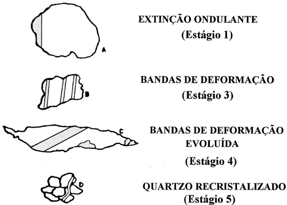
Fig.3.3: Estágio de deformação para o quartzo, segundo Laurent (1974).
