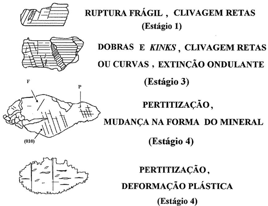
**FIG 3.2:** Estágios de deformação para o feldspato, segundo Laurent (1974).
