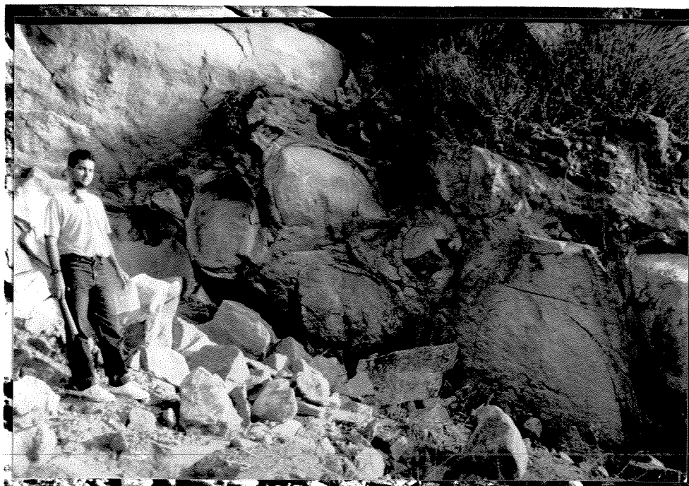
FOTO 1.1. - Processo de Alteração em Maciço Rochoso Gerando Matacões.
