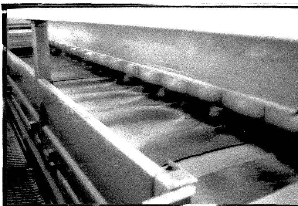
FOTO 1.6. - Polimento de Chapas de Granito com Utilização de Equipamento Automático.
