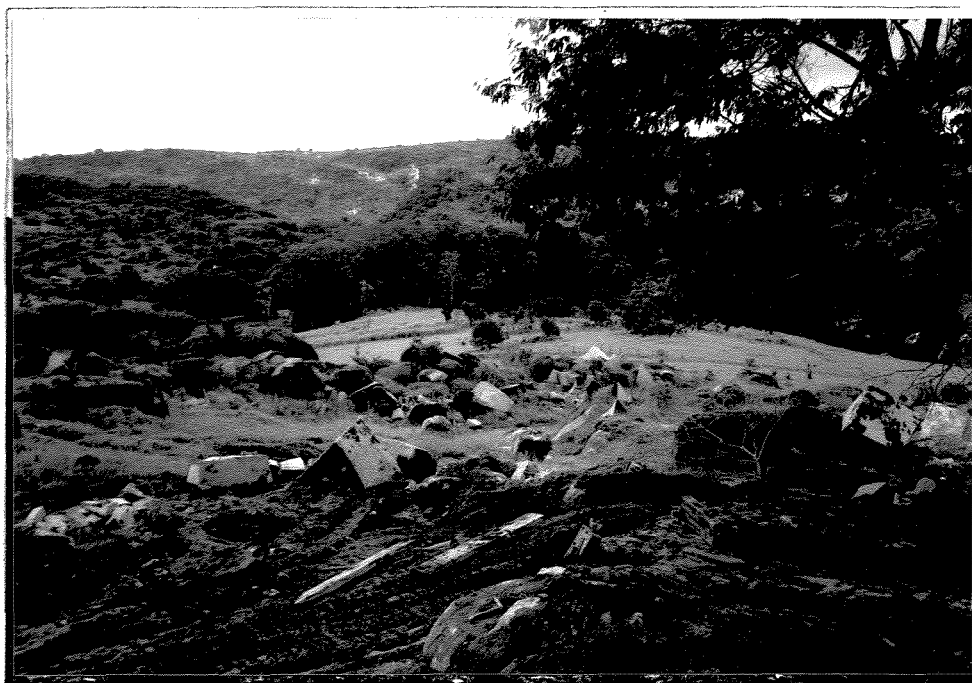
FOTO 4.10. - Valinhos. Detalhe da frente de lavra de uma pedreira para extração de blocos de granitos.
