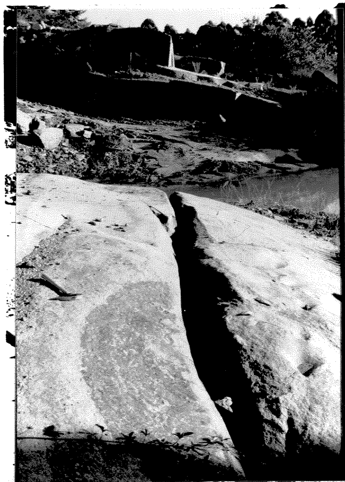
FOTO 4.8. - Lavra do Granito Vermelho Bragança - Braminas Ltda. Detalhe do corte na rocha produzido pelo “ Jet Flame Chanelling System ”.
