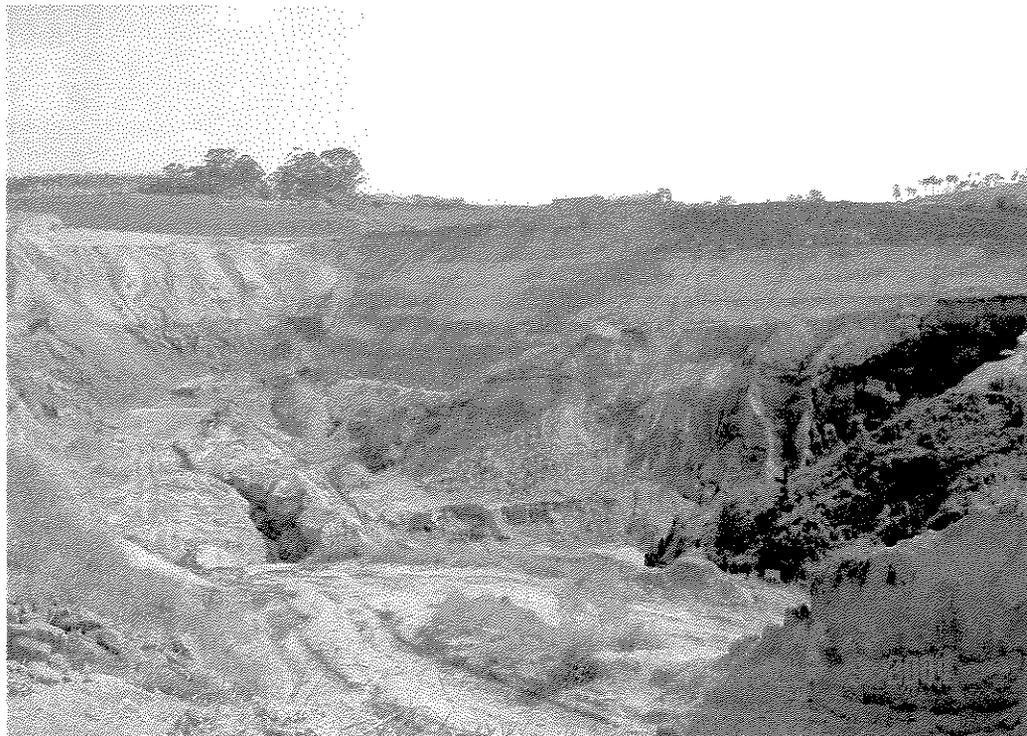
**Foto 3.** Cava de extração de areia da Justo Extração de Areia. Ao fundo, observa-se o reafeiçoamento dos taludes, cuja obra visa a recuperação. A cava deverá ser utilizada como área de disposição de rejeitos, retendo as partículas sólidas da lavagem da areia.(Foto da autora, Set/04).
