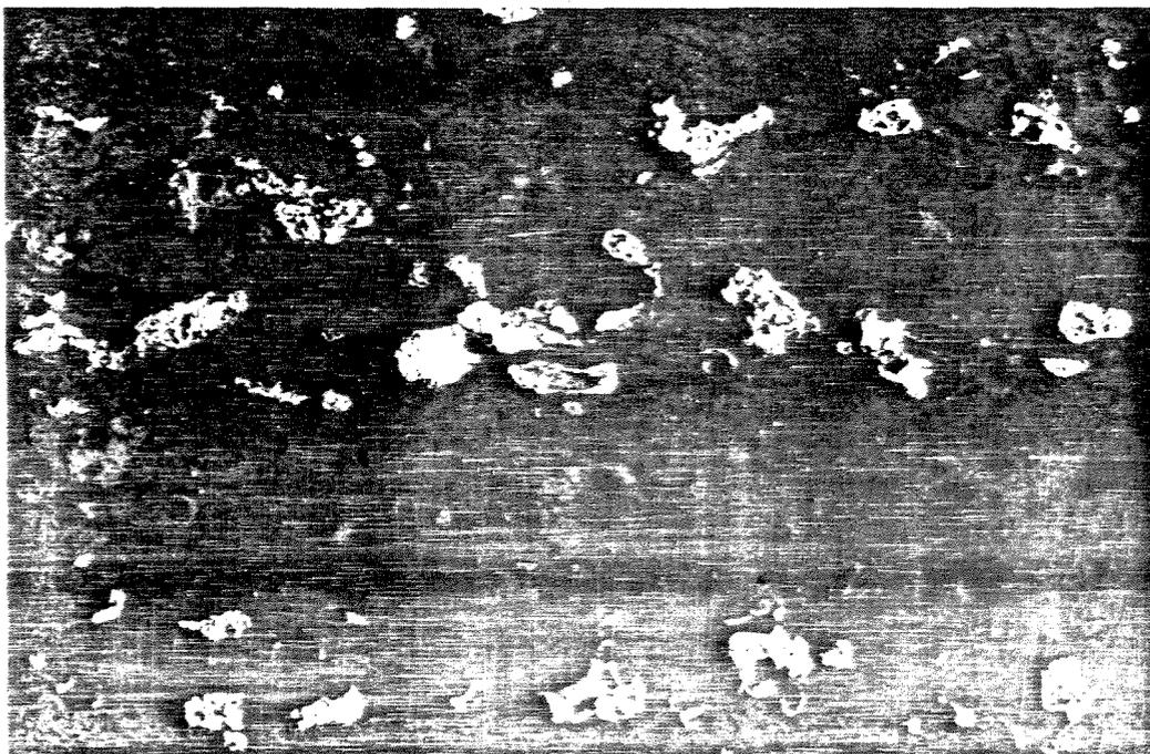
Foto 6.3 - Fotomicrografia mostrando cristais irregulares de pirita ao longo da a foliação Sn (LR). Amostra SGA01-27,75m. Barra=1,0 mm.
