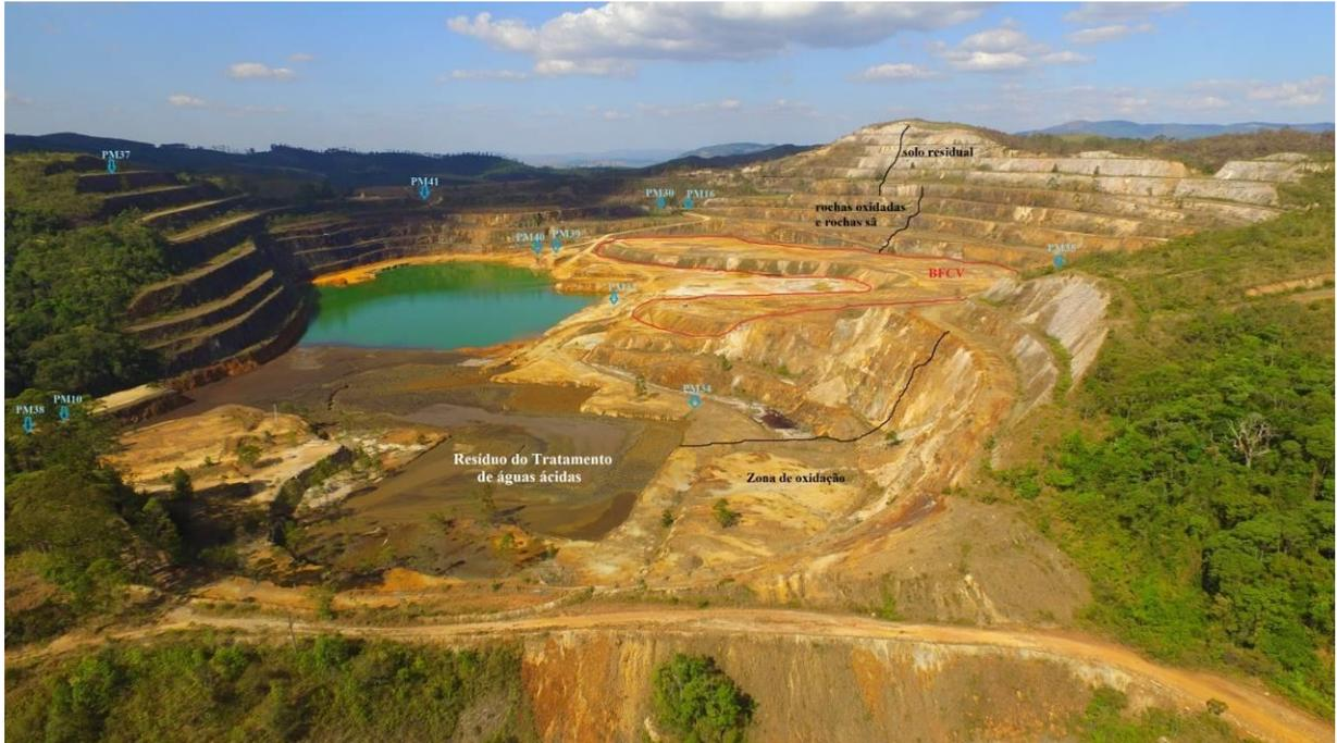
**Figura 4:** Vista aérea da cava da MOU sentido Oeste-Leste e localização dos poços de monitoramento, resíduos do tratamento de águas ácidas – DUCA, da pilha de estéril de triagem do corpo E – BFCV.
