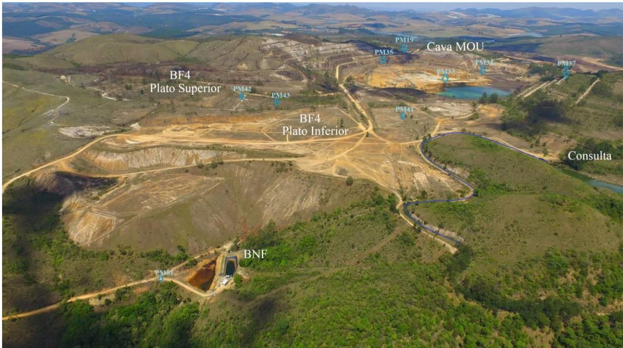
**Figura 5:** Vista panorâmica no sentido Oeste-Leste da pilha de estéril - BF4 (platô inferior e superior) e cava na MOU ao fundo da foto. Localização dos poços de monitoramento, desvio do consulta no canto direito do foto e bacia de contenção de águas ácidas – BNF.
