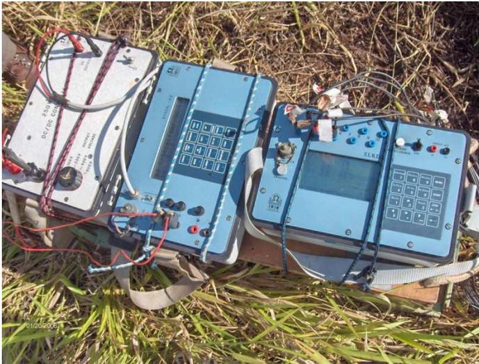
Figura 4.2 – Equipamento utilizado: Syscal – R2 e Elrec Pro.
