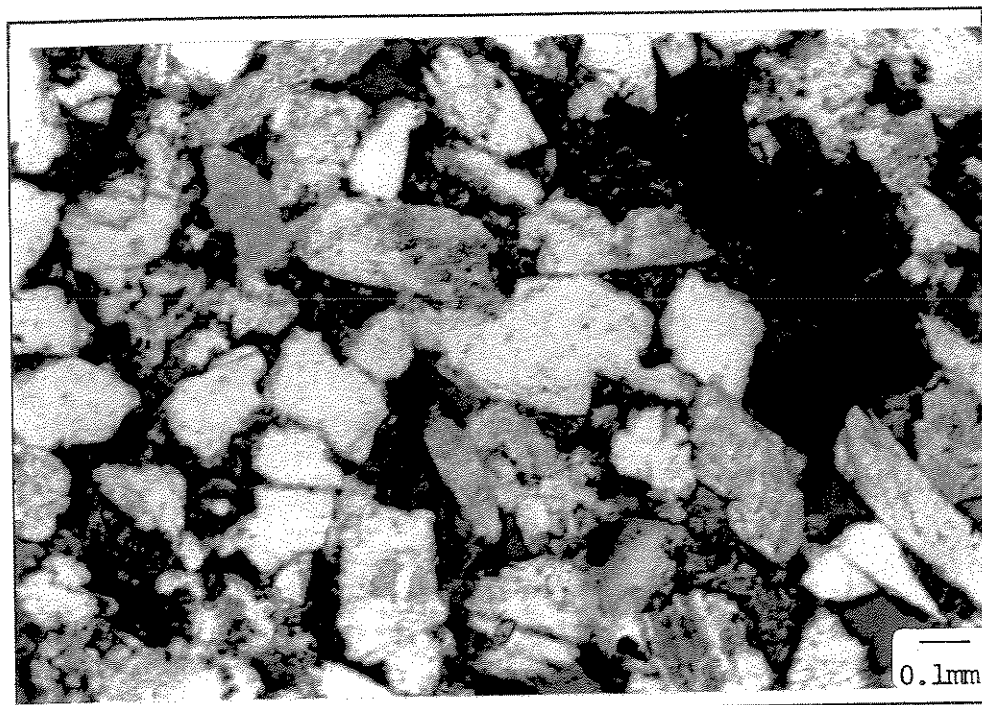
Fig. 2.9 - Cimento de calcita ferrosa, como cristais isolados preenchendo poros reduzidos. Reservatórios deltaicos da Formação Pendência. Fotomicrografia com luz plano-polarizada.
