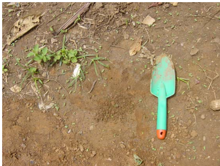
Figura 3.2: Raspagem da camada mais superficial do solo para a coleta das amostras de solos compostas (Solo 4).
